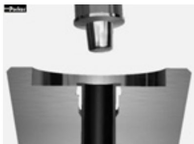
Когда сформируется нужный контур фланца, орбитальное перемещение прекращается и штифт отходит назад
