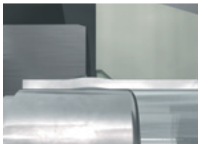
При движении штифт непрерывно деформирует стенку трубы и сжимает ее
